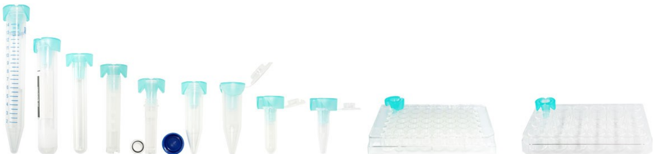
Das Bild zeigt von links nach rechts: konische 15 ml Zentrifugenröhrchen, Blutsammelröhrchen, Durchflusszytometrierröhrchen (FACS™), 3 ml Röhrchen, 2 ml Kryoröhrchen, 5 ml Schraubdeckel für konische Röhrchen, 5 ml Reaktionsgefäß mit Schnappdeckel, 2 ml Reaktionsgefäß, 1,5 Reaktionsgefäß, 48-Well-Platte, 24-Well-Platte
